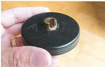
Het restant van de pilaar vormt de basis voor de bevestiging van het N-type chassisdeel.
